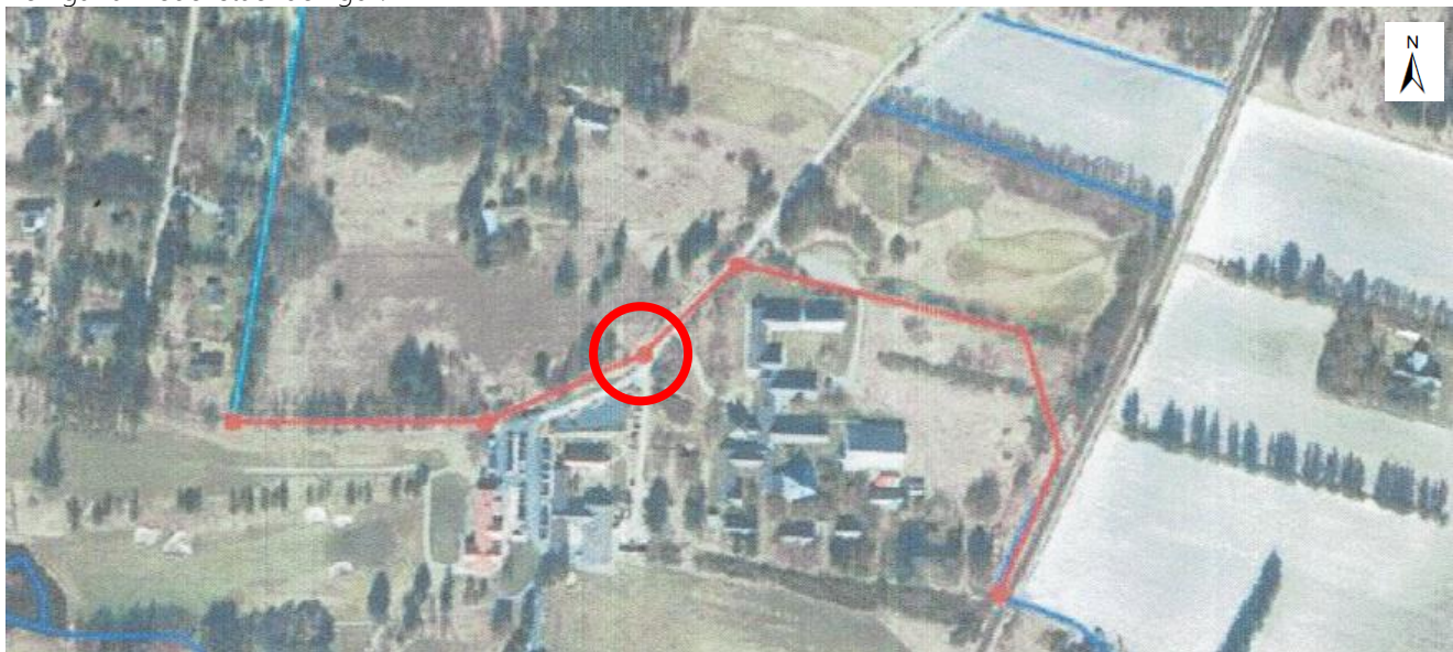
Figur 3: Eksisterende vandløb (blå) og rørlagt grøft (rød) i projektområdet. Brønd, hvori der kan oppumpes til, er markeret med rød cirkel.
