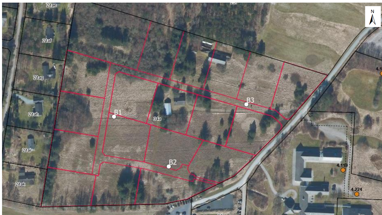
Figur 1: Geotekniske borer foretaget af NIRAS(hvid) samt eksisterende geotekniske borer (orange).
