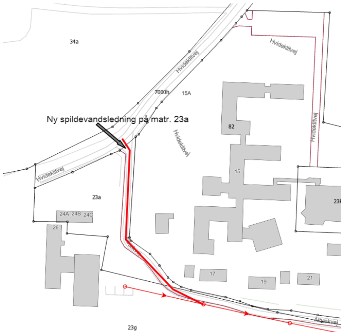
Figur 3: Placering af ny spildevandsledning fra området
