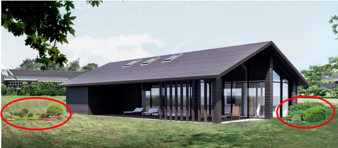
Figur 6.6: Eksempel på individuelle løsninger med regnbede. Regnbede er markeret med røde ringe. Illustration stammer fra ansøgning om lokalplan /12/. De illustrerede bede kan med den rette beplantning enkelt både fungerer som regnvandsanlæg og med den rekreative/visuelle funktion som tiltænkt i lokalplansforslaget.
