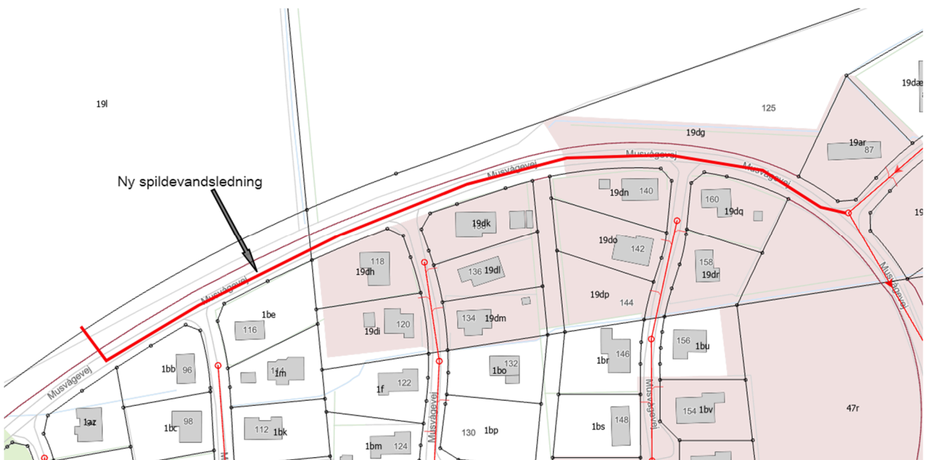
Figur 3: Placering af ny spildevandsledning fra området
