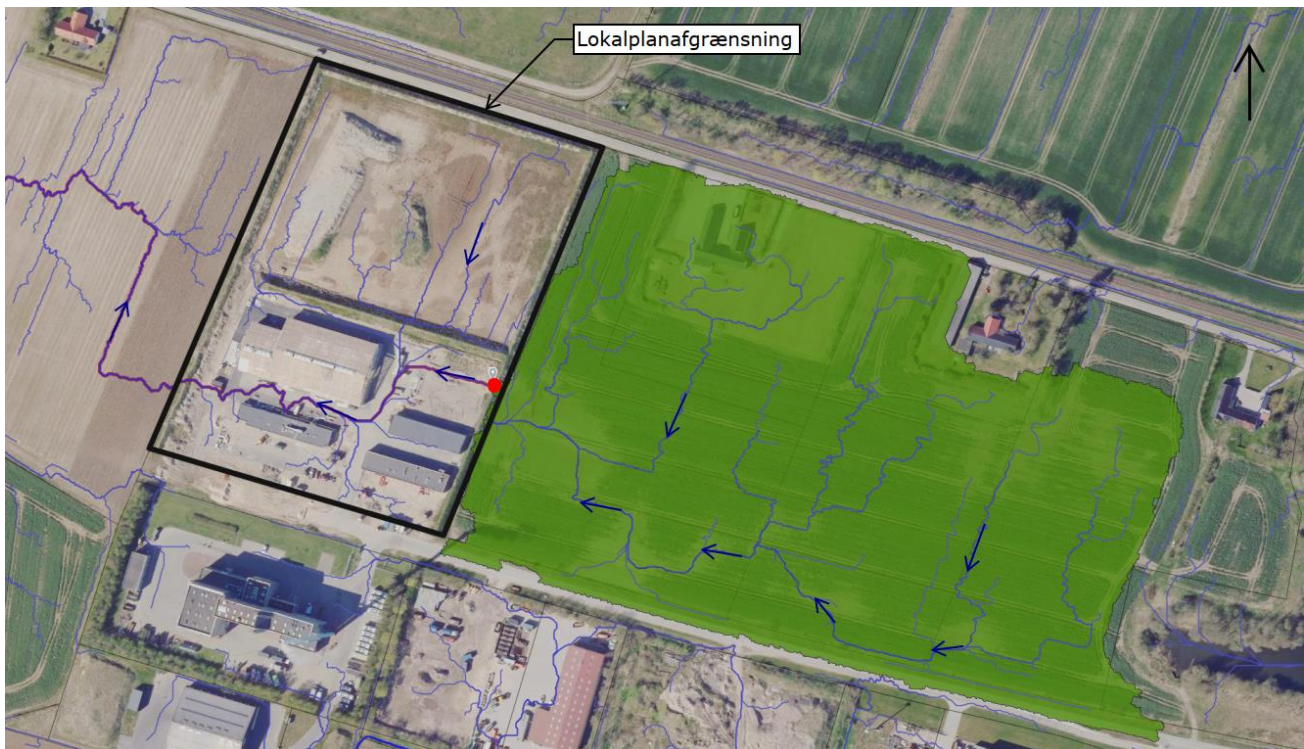
Figur 2.3: Strømningsvejen inden etablering af volde omkring lokalplanområdet samt vandopland på 8,6 ha, som afleder overfladevand til det røde punkt, når jorden er vandmættet. Voldene kan ses på det underliggende ortofoto, men er ikke en del af højdemodellen hvor analysen af strømningsvejene er lavet.
