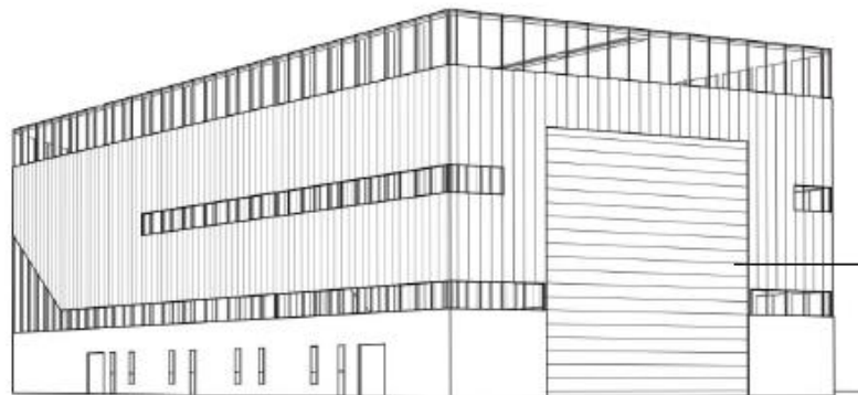
Figur 3-6. Perspektiv af tørdokken fra syd-øst og bassinet, hvor den brede foldeport ses.
