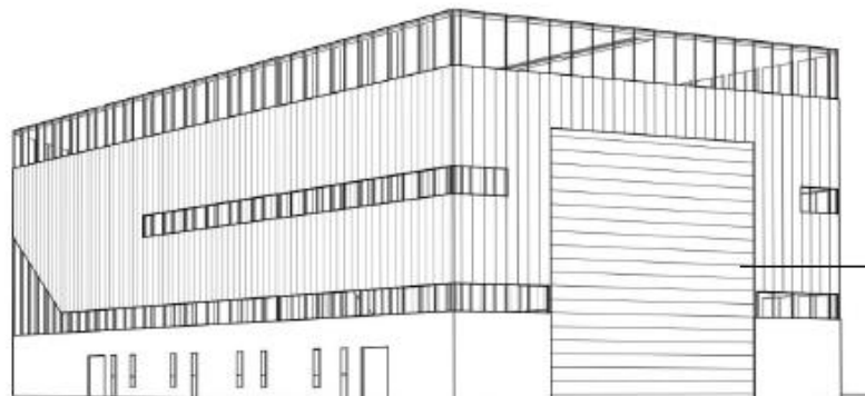
Figur 3-6. Perspektiv af tørdokken fra syd-øst og bassinet, hvor den brede foldeport ses.
