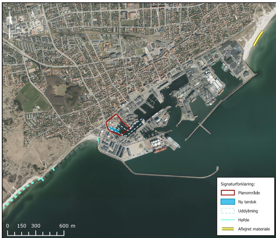
Figur 10-1. Skagen Havn fungerer som en stor høfde, hvor der nordøst for havnen aflejres materiale, mens der sydvest for havnen eroderes materiale.
