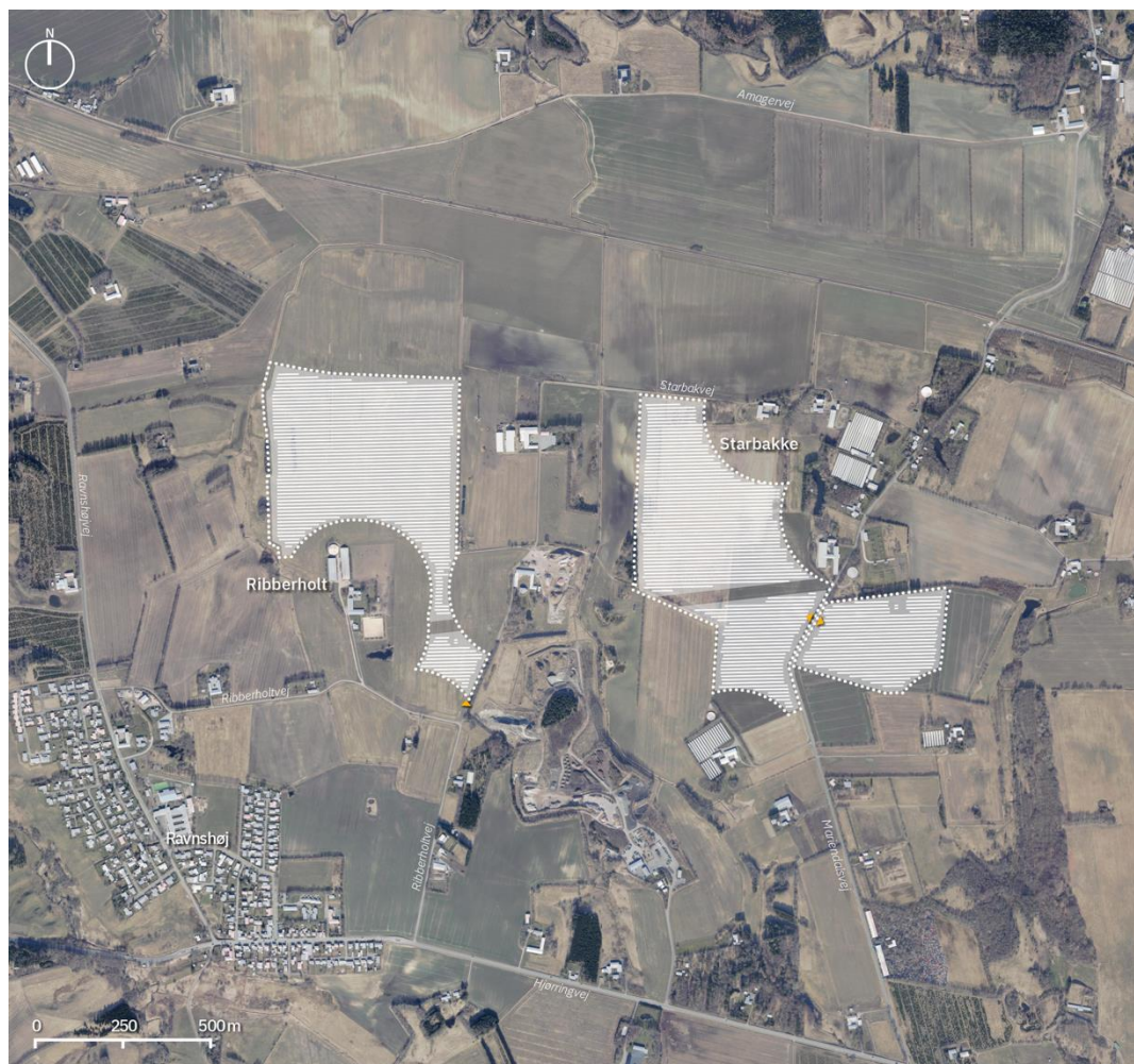
Figur 5.1: Afgrænsning af projektområderne er vist med hvide prikker. Indenfor projektafgrænsningerne ses, med lys skravering, byggefelter for placering af solenergianlæggene, samt adgangsveje med orange markeringer.
