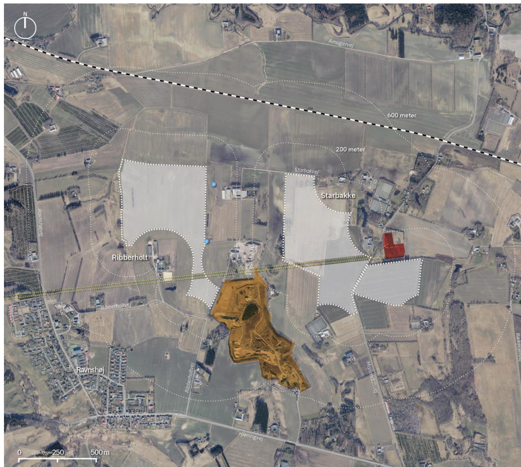
Kort 7.8: Plan- og projektområderne og de omkringliggende højspændingsanlæg vist med gul stiplede linje. Transformerstation er markeret med rød flade. Vindmøller er vist med blå symboler, området med råstofgravning og genbrugsstation er vist med orange flade, og jernbanen er vist med sort-hvid stiplede linje. Plan- og projektområderne er vist med hvid, punkteret linje omkring lyse grå flader.
